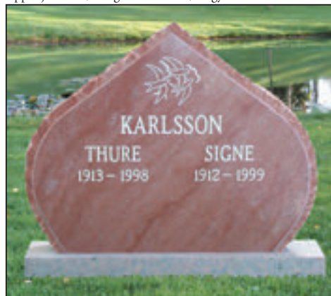
C.177 Wasa granit. Framsidan polerad, kanterna råarbetade med råkantslag, övriga ytor grovslipade. Dekor och text försänkta, gråmålade. Stil: 56.
