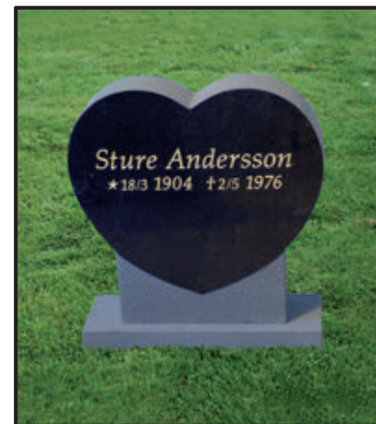
C.245 Svart granit. Framsidan polerad/blästrad. Övriga ytor grovslipade. Text försänkt förgylld. Stil Palatino kursiv
