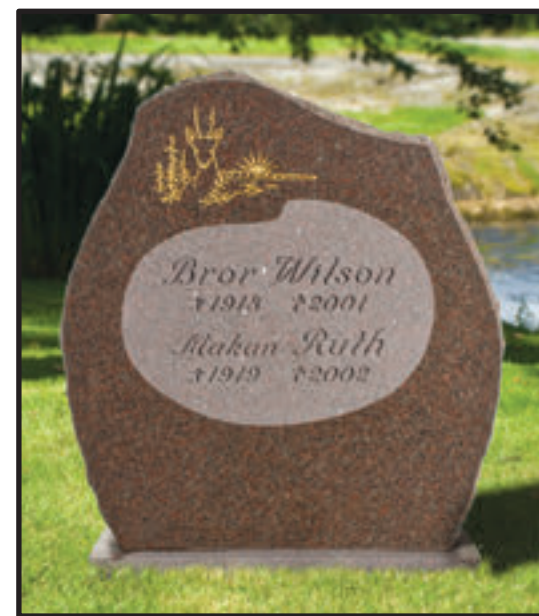
B.199 Röd bohus granit. Framsidan polerad. Kanterna råarbetade. Övr. ytor grovslipade. Dekor försänkt förgyllt. Text djupförsänkt i mattad spegel. Stil 26
